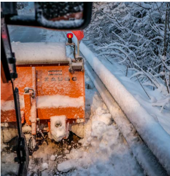
Tadellose Fahrzeugbeherrschung ist eine Grundvoraussetzung. Die Länge des Schilds (2,8 Meter) muss bestmöglich ausgenutzt werden – aber ohne unnötigen Schaden zu verursachen.
