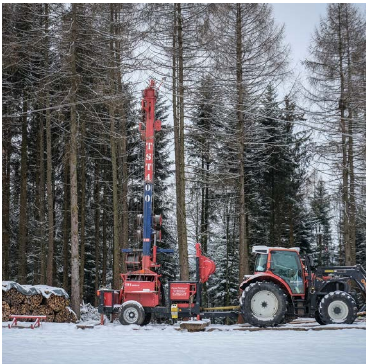
Der Seilkran kann Lasten von bis zu 2 Tonnen transportieren. In diesem Gelände ein grosser Vorteil. Fotos: tiz
