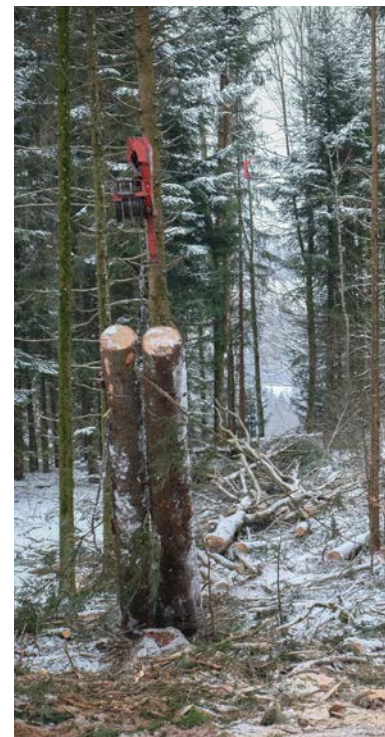
Der Seilkran kann Lasten von bis zu 2 Tonnen transportieren. In diesem Gelände ein grosser Vorteil. Fotos: tiz
